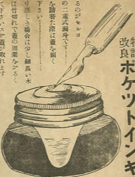
この蓋の中央から下向に突出て居るのがセルロイド製の二重式漏斗です……インクを詰替た際は蓋を固く締めて下さい……蓋の取り回しき場合は少し細長い木切れ又は竹切れで蓋の周圍をかかくたたいて下さい……
